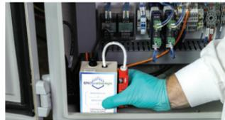
2. El interruptor magnético de seguridad de la unidad también se puede colocar de manera que el otro lado de la unidad mire hacia afuera, proporcionando más opciones de instalación. Use el desarmador de punta torx provisto para desatornillar los pernos, y después voltee el interruptor hacia el otro lado de la caja de montaje y vuelva a fijarlo.
