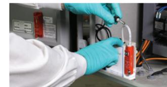
12. Anote la fecha de instalación del foco en la etiqueta adjunta. Reemplace el foco cada 6 meses.
